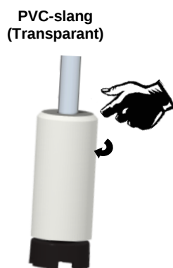
Stap 16 Draai de moer op de kegel aan.
